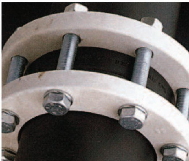
Le raccordement des réseaux PE, en particulier sur des réseaux existants (autres matériaux) ou des organes de type ventouses, bouches d'incendie ou de lavage, peut se réaliser par des collets-bridés électrosoudés, sur des tubes PE de diamètres extérieurs 20 mm à 500 mm.
