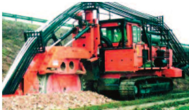
La **trancheuse à chaîne** se différencie par le fait que la roue dentée est remplacée par une chaîne à godets. Ce type de machine permet de réaliser des tranchées plus larges et plus profondes. Un dispositif à bande transporteuse permet d'évacuer les matériaux d'extraction pour les remplacer par un remblai de granulométrie appropriée.
